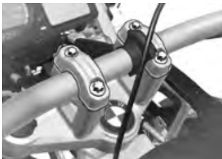
Figuur 2 Stuurstropen 180 graden gedraaid
