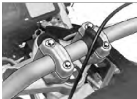
Figuur 1 Originële positie stuurstropen
